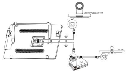
说明:CTP20支持48V/0.27A的电源。 确保CTP20和VCS主机间的连通性,否则会导致CTP20不能正常工作。 你也可以先把CTP20连接到VCM34,再按图上所示连接网络和电源。 如果VCS主机的 VC Hub/Phone 接口被占用,你可以将CTP20接入PoE交换机进行供电,并接入由VCS 主机提供的热点。
