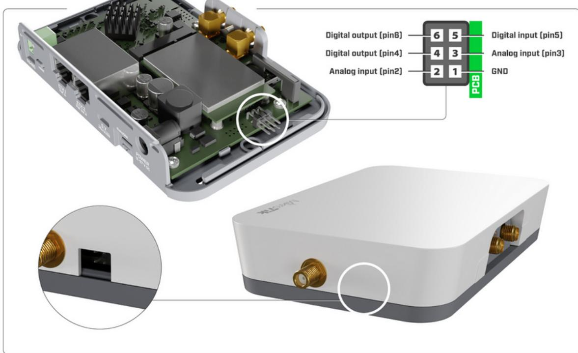
ADC input/analog input (pin2 or pin3):
