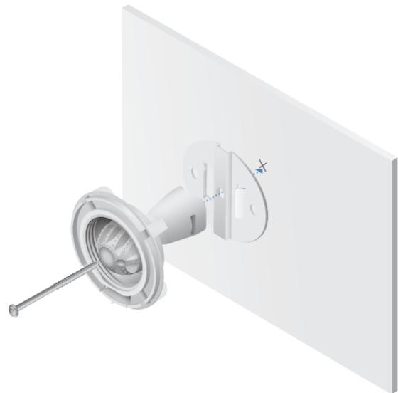
*Kit de montaje en pared de NanoBeam*
